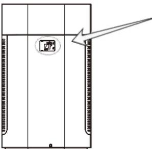
3. Verwenden Sie ein trockenes Wattestäbchen, um den freiliegenden Partikelsensorbereich zu reinigen.
