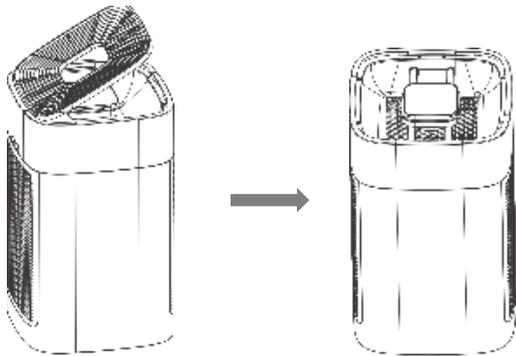
3. Benutzen Sie zur Reinigung des Ionisators ein geeignetes Reinigungswerkzeug, z.B. einen Staubsauger mit einem Bürstenaufsatz bei niedriger Saugkraft, um Staub vom Luftauslass und dem Bereich darunter zu entfernen. Üben Sie dabei nicht zu viel Druck auf das Gerät und das Gitter aus. Die Position des Luftauslasses ist im Kapitel *Produktinformation* zu finden.
