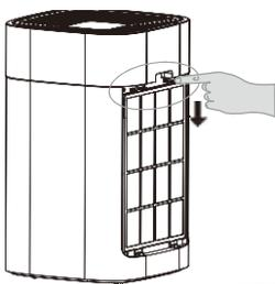
Nehmen Sie auf beiden Seiten die Vorfilter heraus, indem Sie an den jeweiligen Verriegelungen ziehen. Nehmen Sie dann die Hauptfilter heraus, indem Sie an den Streifen ziehen.
