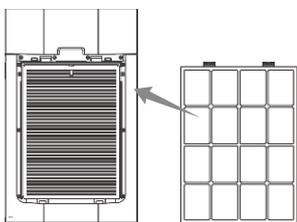
Installieren Sie die Vorfilter auf beiden Seiten.
