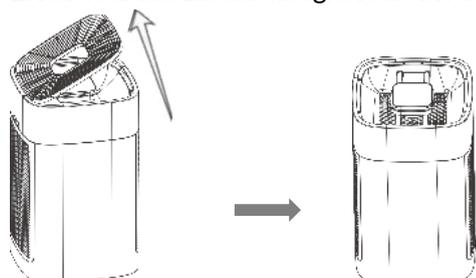
3. Wischen Sie den Luftauslass mit einem trockenen und weichen Tuch aus und entfernen Sie vorsichtig alle Fremdkörper.
