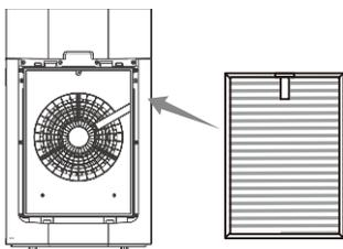
Installieren Sie auf beiden Seiten den Kombifilter HEPA-13 & Aktivkohle.
