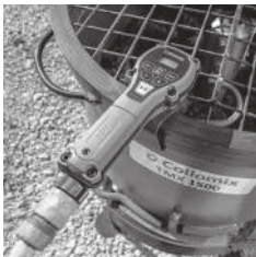
Zawieszanie na bębnie do mieszalnika
