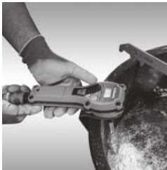
Impostazione del dosaggio in modalità manuale
